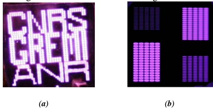
Figure 1: (a) Photo d’une matrice de microplasmas fonctionnant en DC dans l’He (350 Torr) (b) Photo d’une matrice de microplasma en forme de tranchées fonctionnant en AC dans l’Ar (500 mbar)
